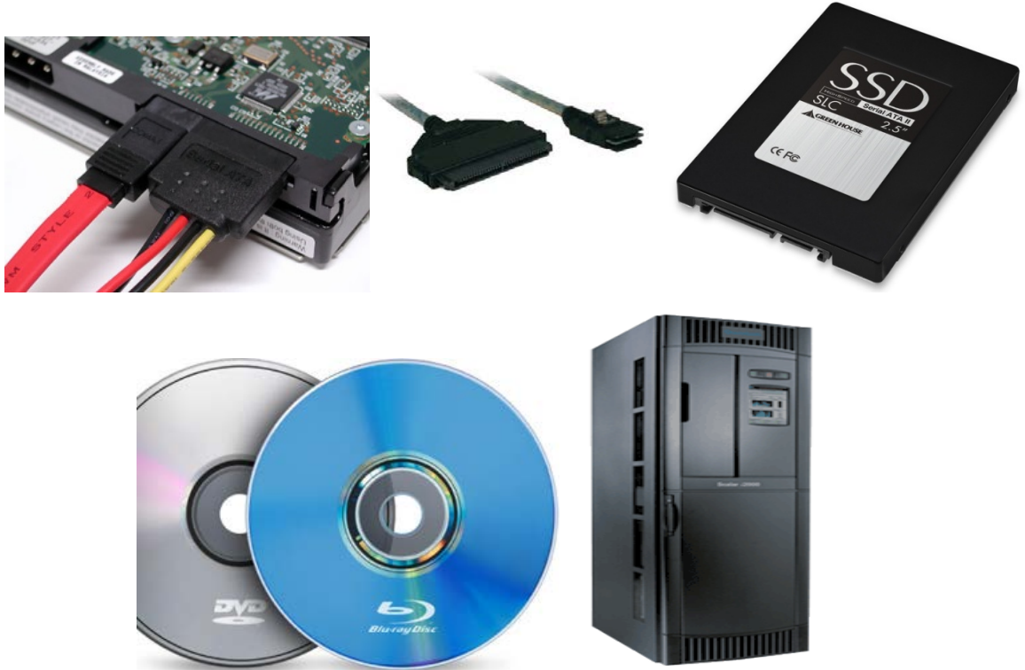
სურ.1.3.1.1 მონაცემთა მრავალდონიანი საცავის კომპონენტები: SATA და SAS-ინტერფეისები, მყარსხეულიანი დისკი (SSD), მაღალტევადი ოპტიკური დისკი Blu Ray, ლენტური მეხსიერების კარადა
